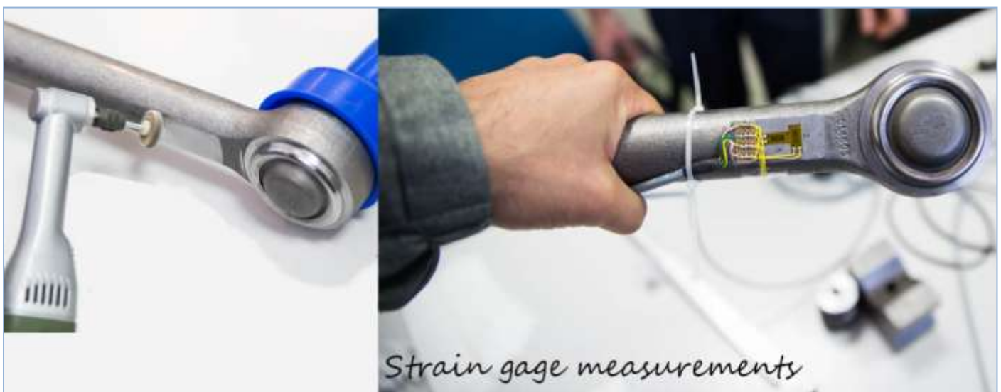
misure del carico assiale su braccetti di sterzo con estensimetri elettrici a resistenza
